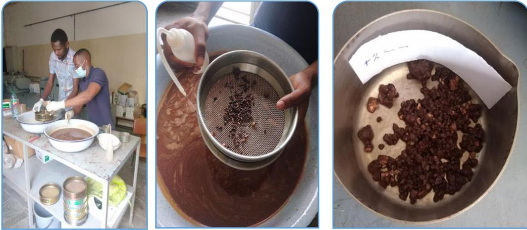
**Figura 3.5:**Ensaio experimental da análise granulométrica de crivagem a húmido.
