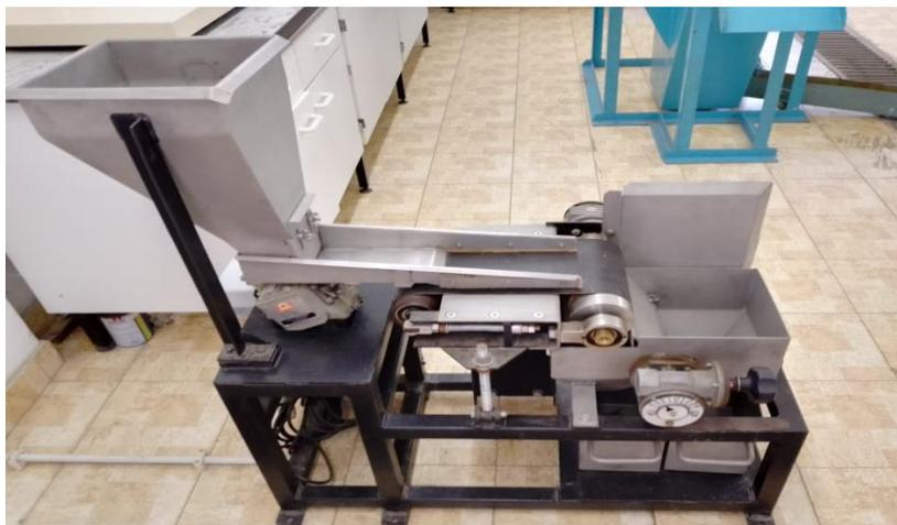
**Figura 2.12:** Separador de ímãs permanentes do laboratório da FEUAN – Minas
