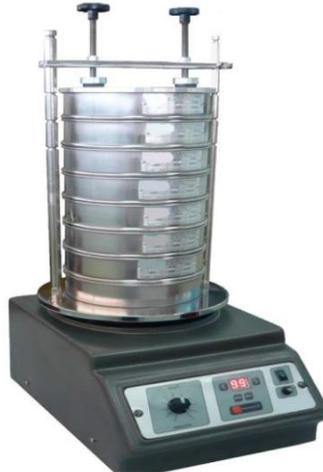
**Figura 2.4:** Pilhas de Crivos utilizadas para o ensaio de análise granulométrica por crivagem. A série de crivos é empilhada de forma que o crivo com maior abertura fica acima da peneira com abertura imediatamente menor e assim sucessivamente.
