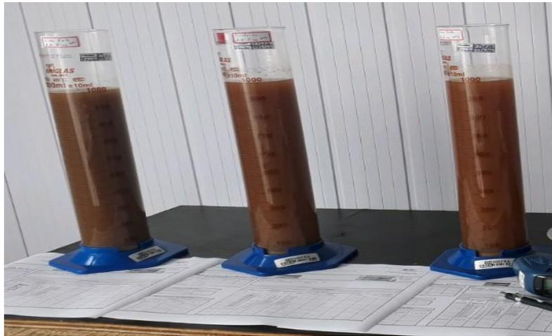
**Figura 2.5:** Teste de análise granulométrica por sedimentação [Fonte: Website guia da engenharia]
