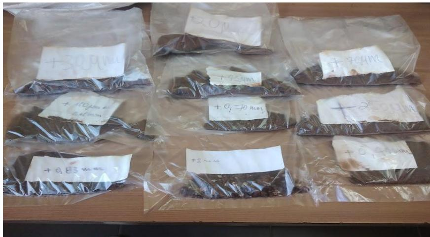
**Figura 3.8:** Classes granulométricas obtidas e acondicionadas em saquetas.
