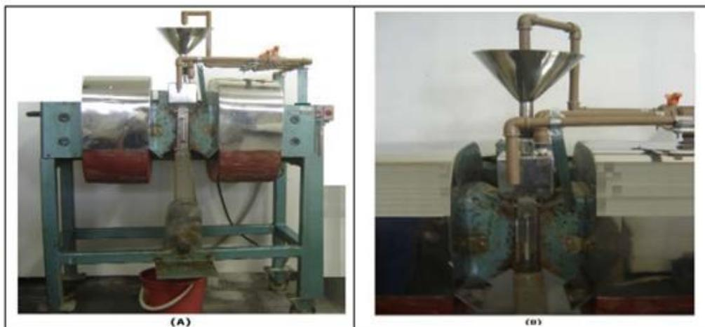
**Figura 2.15:** Separador magnético a húmido de alta intensidade. [Fonte: CETEM]
