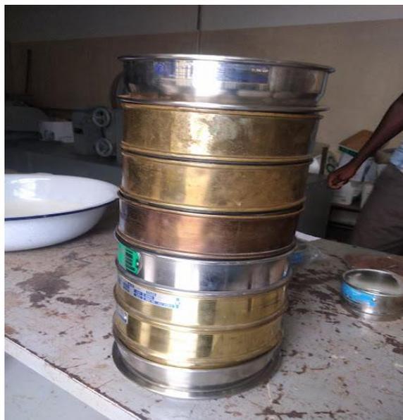
**Figura 3.4:**Série de crivos usados no processo de análise granulométrica por crivagem à húmido.
