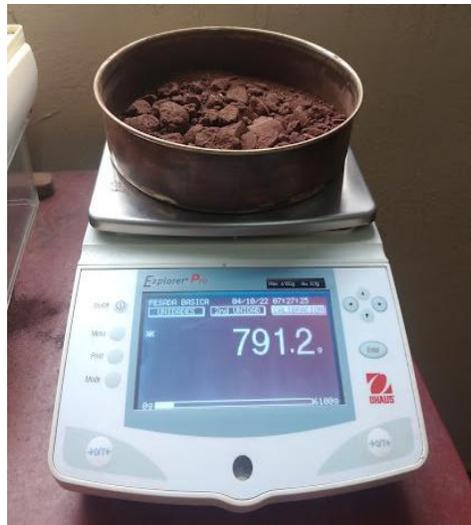
**Figura 3.3:**Peso de  $\frac{1}{4}$  da amostra usando a balança Explor Pro. [Fonte: Os Autores]
